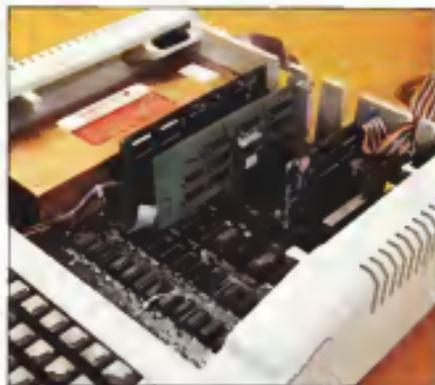
Fig. 1. Il nuovo sistema di controllo del Corvus. In alto: il Control Panel. Sotto: il Control del Corvus (slot 2) e il Control del software (slot 3).
